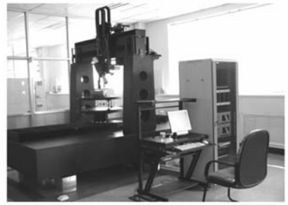
图 2 FSGJ-2 非球面数控加工中心
